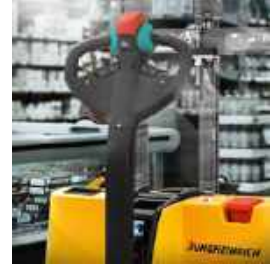
Einfach und sicher manövrieren: die Sicherheitsdeichsel der Mitgängerfahrzeuge.
