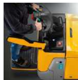
Die Elektro-Niederhubwagen für die Mittelstrecke verfügen über Standplattformen.
