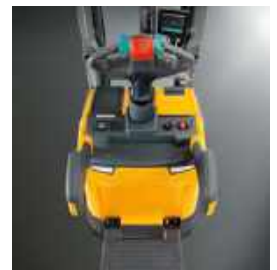
Viel Bewegungsraum auch für den Bediener: die Standplattform des ERC 216z.
