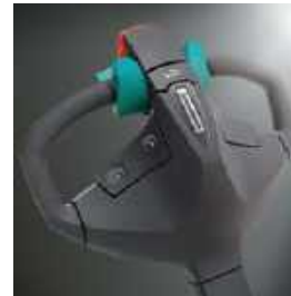
Einfach und sicher manövrieren: die Sicherheitsdeichsel der Mitgängerfahrzeuge.
